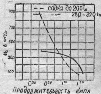
Фиг. 5—Зависимость между количеством  $H_2$  в стали перед раскислением и продолжительностью кипения.
