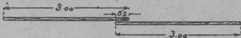
Фиг. 18. Настил в отдельных слоях межкамерн. целика № 7/10 на Лутугинском пласте ш. № 2.
